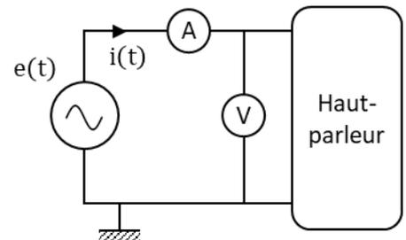
Mesurer les valeurs efficaces  $E_{\text{eff}}$  et  $I_{\text{eff}}$  pour des fréquences allant de 10 Hz à 20 kHz. Choisir l'amplitude du signal d'entrée en fonction de la pénibilité du bruit (20 V aux basses fréquences, mais moins autour de 1 kHz ...). Choisir des fréquences régulièrement espacées (en échelle logarithmique) : 10, 20, 30, ..., 100, 200, 300, ..., 1000, 2000 Hz.
