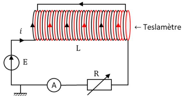
Remarque : on peut vérifier rapidement que si les deux enroulements sont branchés dans le sens inverse, les deux champs magnétiques générés ont la même amplitude mais sont de sens opposé. Ainsi,  $B = 0$ .
